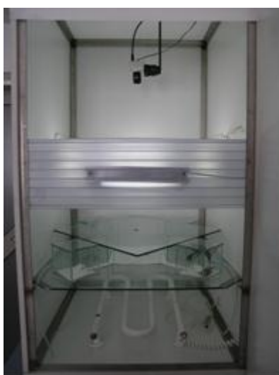
Fot. 7. Kamera wideo Ikegami 49E-ICD do obserwacji zachowania żerdzianki sosnówki w olfaktometrze
