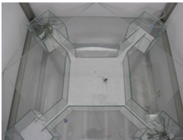
Fot. 6. Olfaktometr do badań preferencji zapachowych u żerdzianki sosnówki
